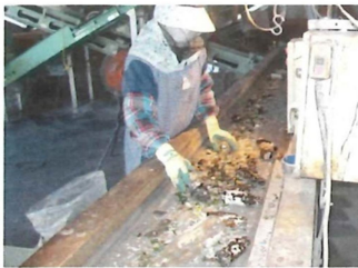
③ 手選別コンベア ガラスびんに混じっている異物を取り除きます。
