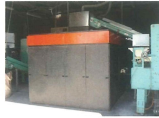
⑦ 振動ふるい機 ガラス粒を大きさに別に分けします。
