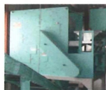
⑫第2風力選別機 製品中の異物を除去します。
