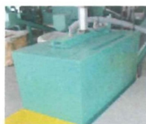
⑬スパイラル破碎機 薄型パネルやソーラーパ ネルをそのまま投入し破碎しま す。
