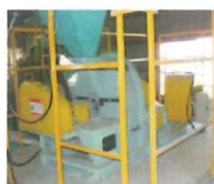
⑮スーパーミル 破碎後のガラスのエッジレス 加工（角取り）を行います。
