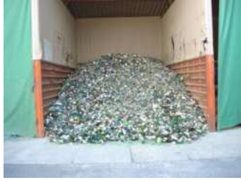
① びんガラス破碎前保管ヤード
