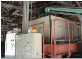
⑥ 二次破碎機 破碎したガラス粒の角を取ります。
