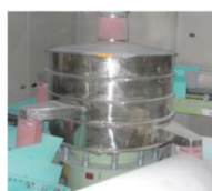
⑦振動ふるい機 粒度ごとに製品をふるい分けします。（4種分級）
