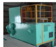
㉓ロータリーカッター アルミ付プラズマパネルやソーラーパネルをそのまま投入し破砕します。
