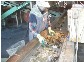
③ 手選別コンベア ガラスびんに混んでいる異物を取り除きます。
