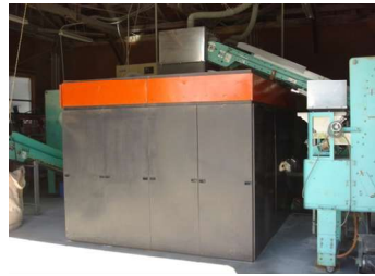
⑦ 振動ふるい機 ガラス粒を大きさ別にふるい分けします。
