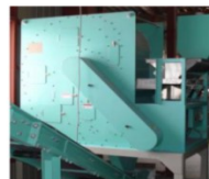
⑭第2風力選別機 製品中の異物を除去します。
