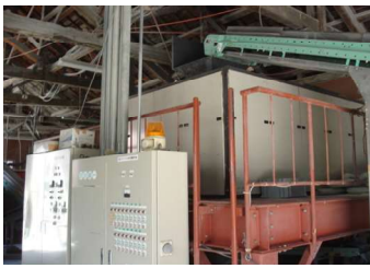
⑥ 二次破碎機 破碎したガラス粒の角を取ります。
