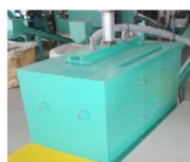
⑱スパイラル破砕機 薄型パネルやソーラーパネルをそのまま投入し破砕します。
