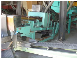
⑤ 金属検出機 金属異物を取り除きます。
